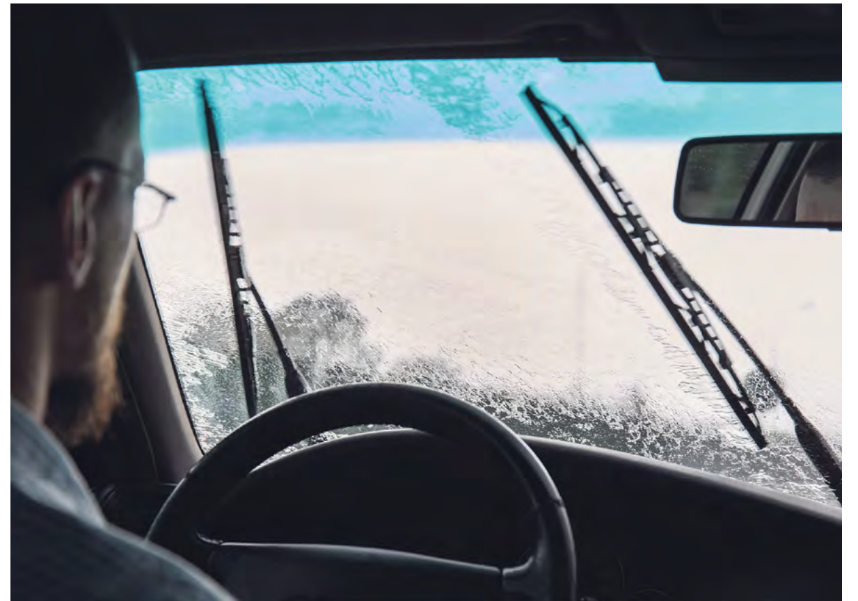
Nervt nicht nur ziemlich, sondern ist auch gefährlich: Abgenutzte Scheibenwischer, die das Glas nicht richtig säubern, sondern eine Schmierschicht hinterlassen. Foto: Pixabay
