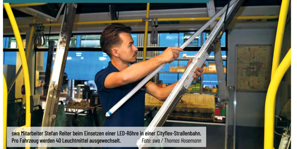
swa Mitarbeiter Stefan Reiter beim Einsetzen einer LED-Röhre in einer Cityflex-Straßenbahn. Pro Fahrzeug werden 40 Leuchtmittel ausgewechselt.
